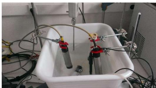
Salle de calibration et différentes étapes pour la calibration des capteurs de turbidité, de salinité et d'oxygène dissous
