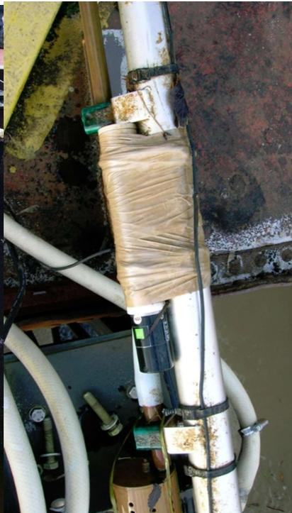
En période estivale, une sonde autonome d'oxygène dissous (optode, Bordeaux Métropole) est placée sur la cage pour sécuriser la mesure de ce paramètre critique. Ce type de capteur nécessite des visites régulières pour récupérer les données, limiter le développement de dépôts sur la surface du capteur et pour vérifier le niveau de charge des piles.
