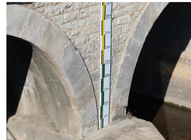
Exemple d'échelle limnimétrique rattachée au PCS communal (crédit photo : SPCGD)
