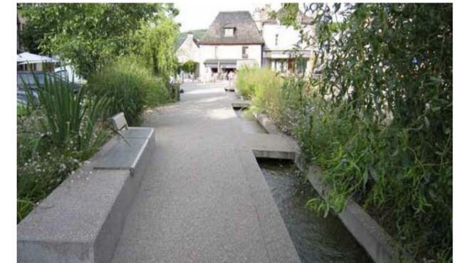
Rigoles d'évacuation des eaux pluviales
