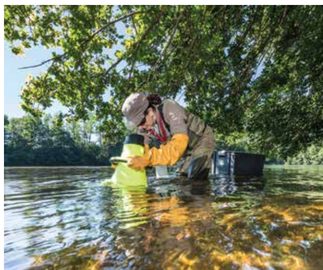
▲ Utilisation d'un bathyscope dans le cadre d'une campagne de prélèvement. (© AQUABIO)
